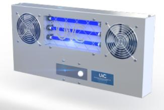
El sistema UV ROOF está diseñado para usarse como parte de un programa continuo de desinfección. Este equipo elimina los patógenos de un ambiente cerrado, mediante la extracción de aire y paso a través de luces germicidas UVC confinadas.
